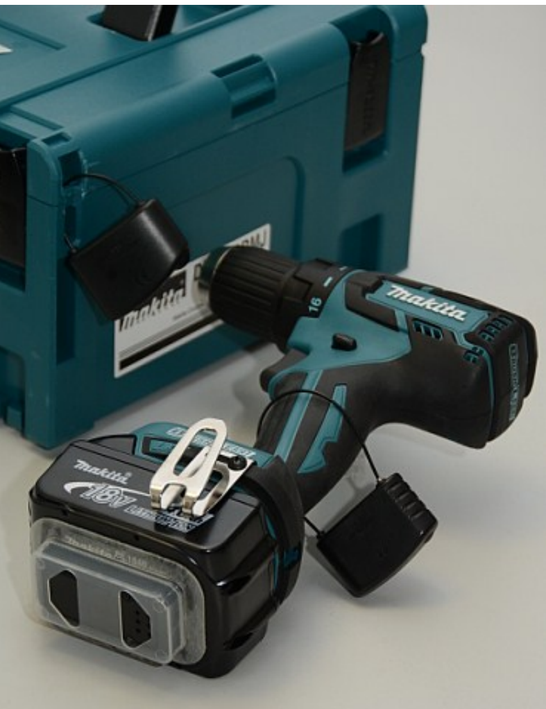
Media Tag mit Carrier am Akku, 4-Alarm Lanyard tag am Schrauber
