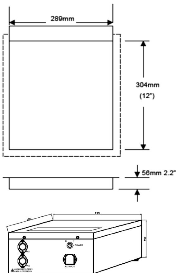
Leistungsfähiger Deaktivator für akustomagnetische Klebeetiketten.
