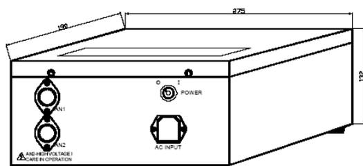
Leistungsfähiger Deaktivator für akustomagnetische Klebeetiketten speziell für den Einbau in Rollbänder von SB-Kassentischen.
